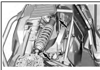
PIÈCES REPRÉSENTÉES DÉPOSÉES POUR PLUS DE CLARTÉ - FIXATIONS D'AMORTISSEUR AVANT
