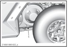
TYPICAL - LEFT SIDE OF VEHICLE UNDER CARGO BOX 1 CVT drain
