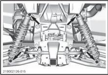
REAR SHOCK ABSORBER FASTENERS
