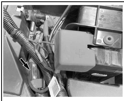
ESEMPIO TIPO - PORTAFUSIBILI DEL REGOLATORE
