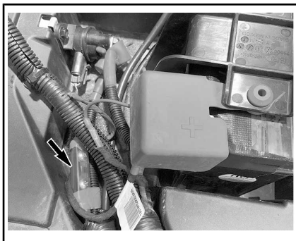
ТИПОВОЙ ВАРИАНТ — ПАТРОН ПЛАВКОГО ПРЕДОХРАНИТЕЛЯ РЕГУЛЯТОРА
