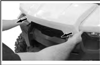
ESEMPIO TIPO - TIRARE DAL BORDO COPERCHIO DI MANUTENZIONE ANTERIORE.
