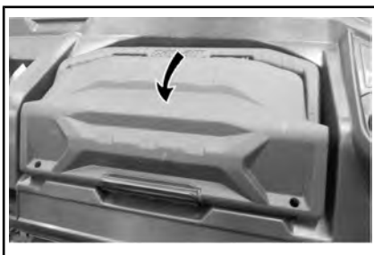
SBLOCCO DELLA CASSETTA DEGLI ATTREZZI ESTRAIBILE
