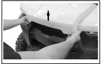
ESEMPIO TIPO - SOLLEVAMENTO DEL BORDO DEL COPERCHIO DI MANUTENZIONE ANTERIORE
