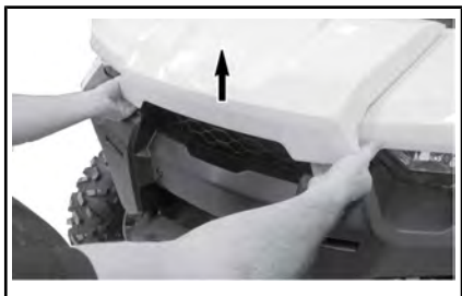
LEVER LE BORD DU COUVERCLE D'ENTRETIEN AVANT.
