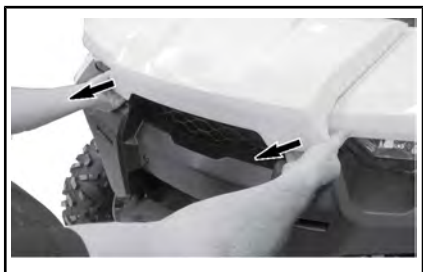
TIREZ SUR LE BORD AVANT DU COUVERCLE D'ENTRETIEN.
