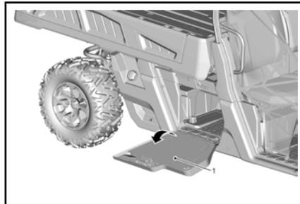
Desmonte la tapa de la batería desatornillando los dos fijadores de 1/4 de vuelta.
