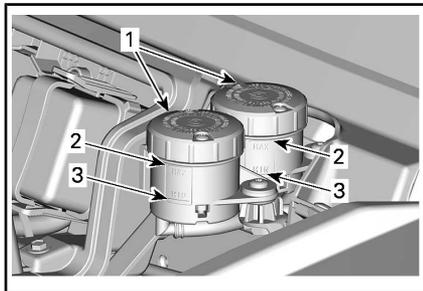
1. Depósitos de líquido de frenos
