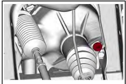
*VISCO-LOK TÍPICO - LATERAL DERECHO DELANTERO DEL VEHÍCULO*
