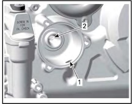
1. Einlass-Bohrung der Ölpumpe zum Ölfilter
