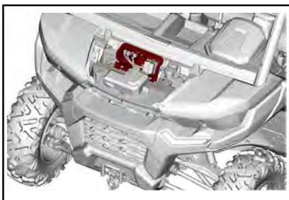
**SICHERUNGSKASTENHALTERUNG – TYPISCH**
