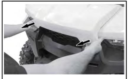
**AN DEN VORDEREN KANTEN DER WARTUNGSABDECKUNG ZIEHEN.**
