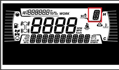
Diese Anzeige zeigt die Getriebestellung an:
