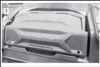
Zum Öffnen der Werkzeugbox lösen Sie die Abdeckung und heben den Deckel.
