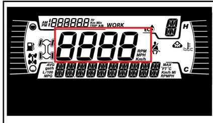
Anzeige der Fahrzeuggeschwindigkeit in km/h oder mph.
