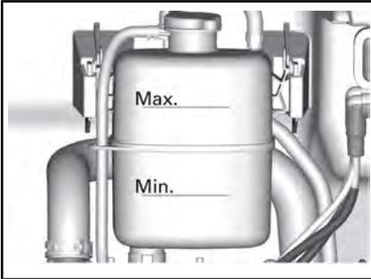
5. Geben Sie nach Bedarf Kühlmittel in das System. Mit einem Trichter vermeiden Sie das Verschütten von Flüssigkeit. **Nicht überfüllen.**
