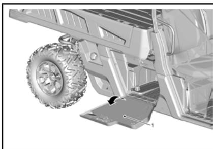
Schrauben Sie zum Entfernen der Batterieabdeckung die beiden Bajonnettverschlüsse ab.
