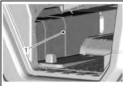
1. Крышка аккумуляторной батареи
