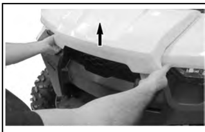
LEVER LE BORD DU COUVERCLE D'ENTRETIEN AVANT.
