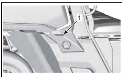
1. Alça de liberação do compartimento de carga
