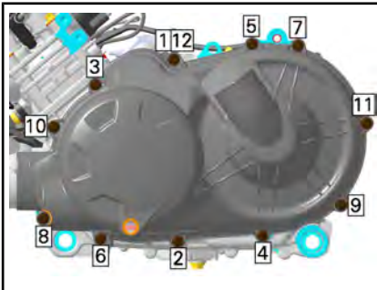
HD5 - SÉQUENCE DE SERRAGE DU COUVERCLE DE LA BOÎTE CVC
