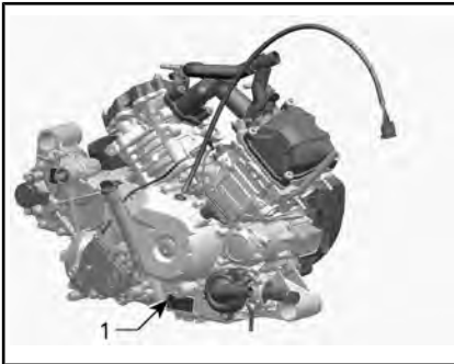
TYPISCH HD8 UND HD10 — HINWEISSCHILD MIT MOTORSERIENNUMMER
