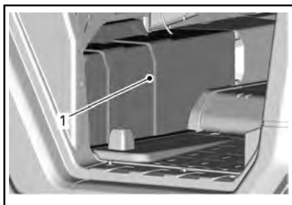
1. Крышка аккумуляторной батареи
