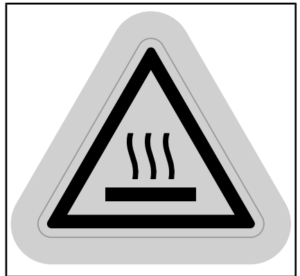
SURFACE CHAUDE - PRÈS DE LA SUSPENSION ARRIÈRE
