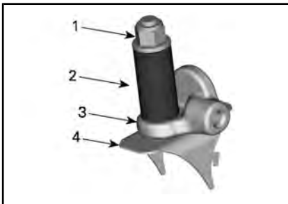
ЗАДНЯЯ ТОЧКА КРЕПЛЕНИЯ В ВЕРХНЕМ ПОЛОЖЕНИИ
