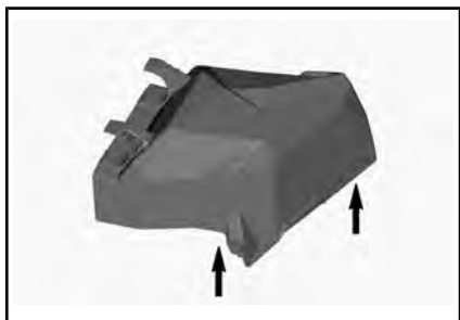
LØFTE BAKSIDEN AV SERVICEDEKSELET
