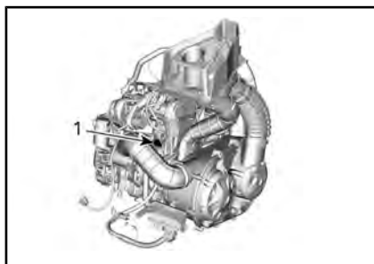
TYPIQUE — ÉTIQUETTE DU NUMÉRO DE SÉRIE DU MOTEUR
