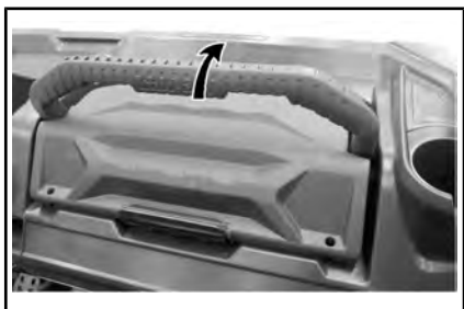
DE GEREEDSCHAPSKIST OP ZIJN PLAATS BEVESTIGEN
