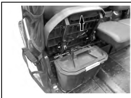
DE AFNEEMBARE GEREEDSCHAPSKIST ONTGRENDELEN
