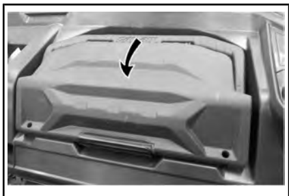
DE AFNEEMBARE GEREEDSCHAPSKIST ONTGRENDELEN
