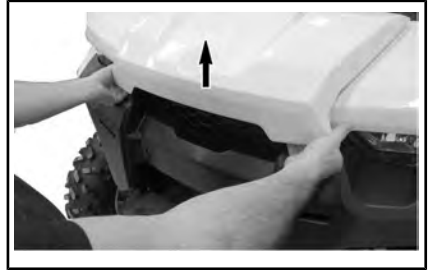
TYPISCH - WARTUNGSABDECKUNG HOCHHEBEN.
