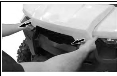
TYPISCH - AN DEN VORDEREN KANTEN DER WARTUNGSABDECKUNG ZIEHEN.
