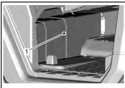
1. Крышка аккумуляторной батареи
