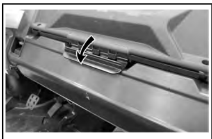
DESBLOQUEIO DA TAMPA
