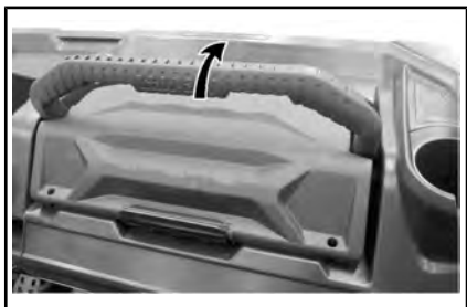
FIXAÇÃO DA CAIXA DE FERRAMENTAS NO LUGAR
