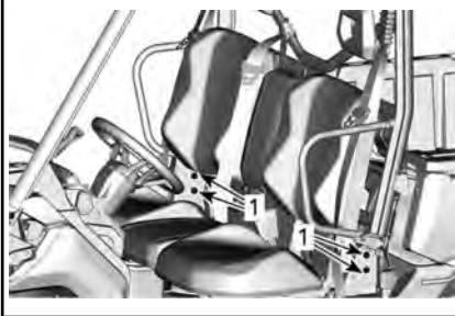
1. Элементы крепления верхней рамы каркаса безопасности
