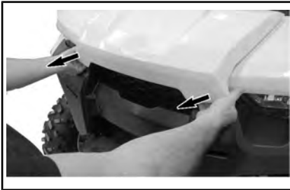
PUXANDO A BORDA DA TAMPA DE MANUTENÇÃO FRONTAL.
