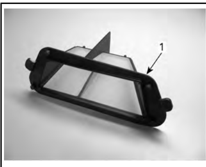
1. Filtro de aire de la CVT
