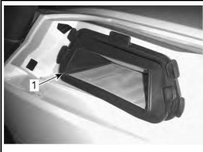
1. Filtro de aire de la CVT
