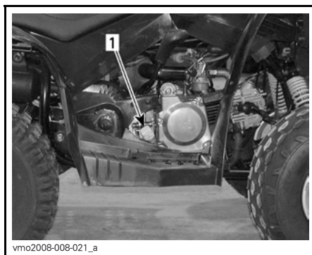
TYPBILD — HÖGER SIDA AV MOTORN 1. Oljemätsticka
