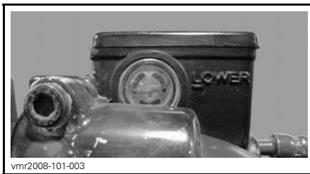
BAKRE BROMSVÄTSKEBEHÅLLARE PÅ VÄNSTER SIDA
