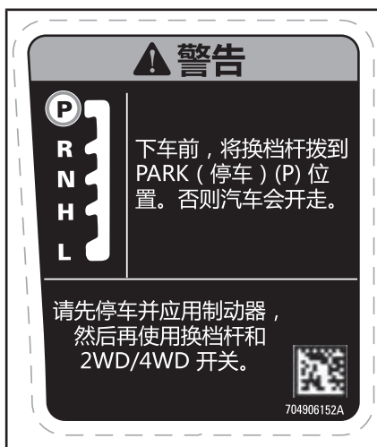
标签 4 - 未配备 Smart-Lok™ 差速器的型号
