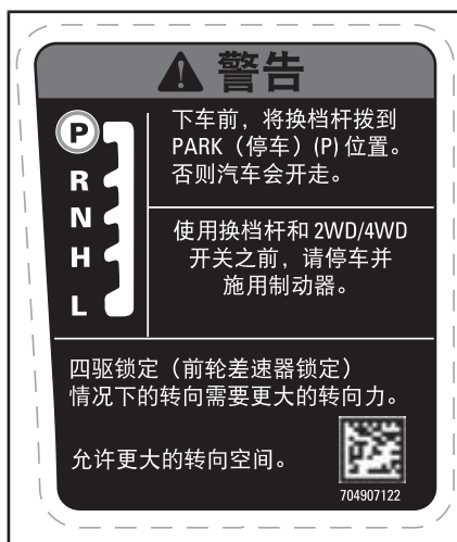
标签 4 - 配备 Smart-Lok 差速器的型号
