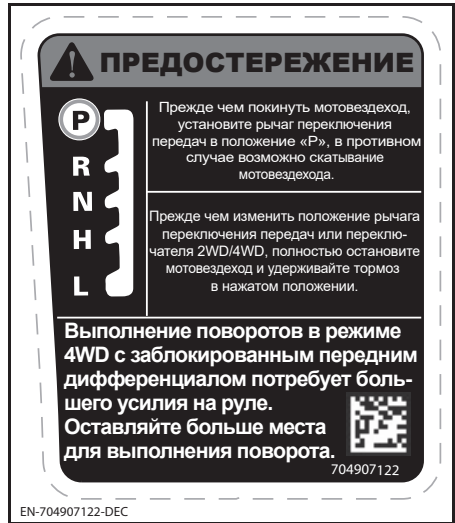
НАКЛЕЙКА 4 - МОДЕЛИ, ОБОРУДОВАННЫЕ ДИФФЕРЕНЦИАЛОМ SMART-LOK™
