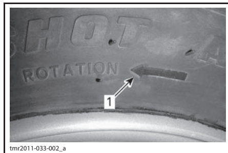
ТИПОВОЙ ВАРИАНТ 1. Направление вращения
