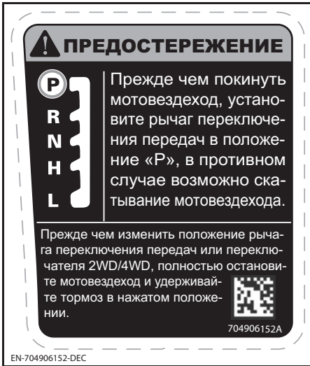
НАКЛЕЙКА 4 - МОДЕЛИ, НЕОБОРУДОВАННЫЕ ДИФФЕРЕНЦИАЛОМ SMART-LOK™
