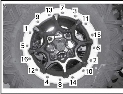
TYPISCH - AANDRAAIVOLGORDE
