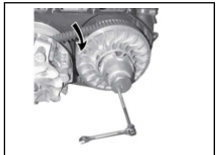
REKKEFØLGE FOR STRAMMING AV CVT-DEKSEL
