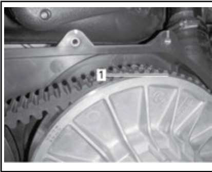
1. Het onderste deel van de tangen gelijk met de buitenkant van de aandrijfriem
