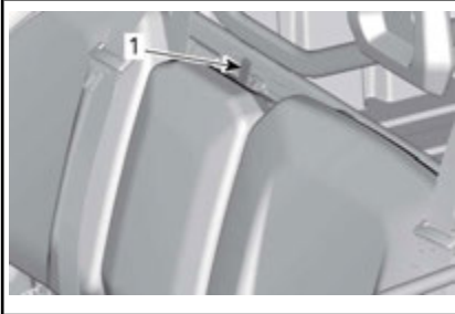
1. Clip van het vergrendelmechanisme van de rugsteun
