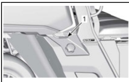
1. Utløserhåndtak for lasterom
