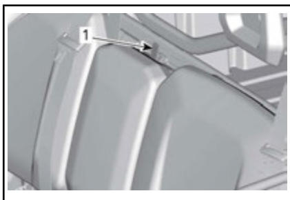
1. Låsemekanismen på ryggstøtten
