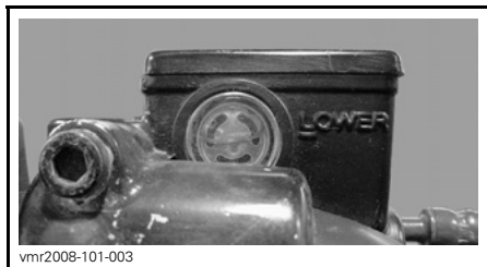
DEPÓSITO DE LÍQUIDO DE FRENOS DE LA PARTE TRASERA, EN EL LADO IZQUIERDO
