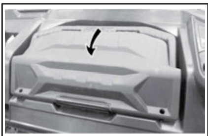
DE AFNEEMBARE GEREEDSCHAPSKIST ONTGRENDELEN
