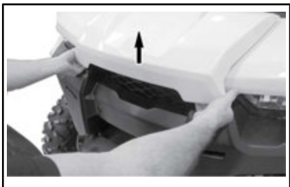
DE RAND VAN HET VOORSTE ONDERHOUDSDEKSEL OPTILLEN.
