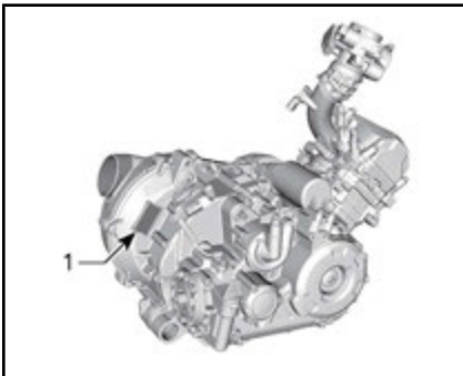
TYPISCH HD5— LABEL MET SERIENUMMER MOTOR
