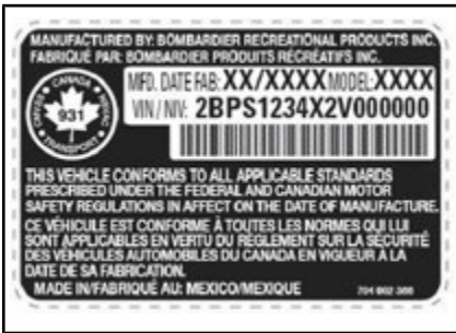
NORMAAL: ETIKET MET SERIENUMMER VOERTUIG ONDER HANDSCHOENVAK
