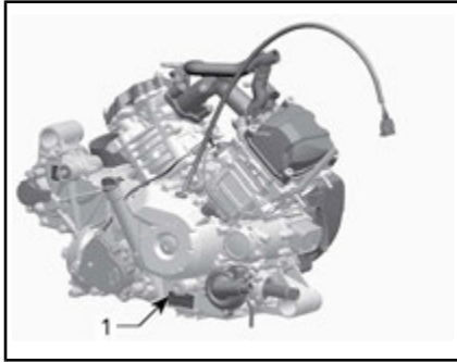
TYYPILLINEN HD8 JA HD10 — MOOTTORIN SARJANUMEROKILPI
