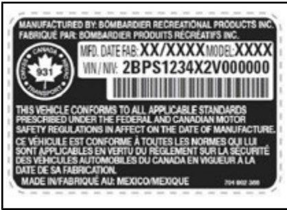
TYYPILLINEN — AJONEUVON SARJANUMEROKILPI HANSIKASLOKERON ALLA
