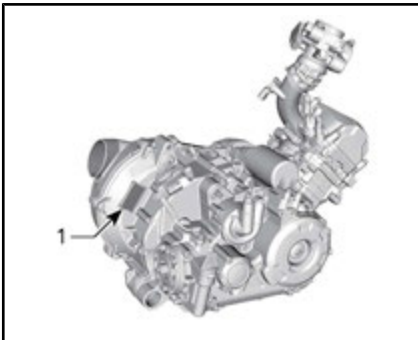
TYYPILLINEN HD5 — MOOTTORIN SARJANUMEROKILPI
