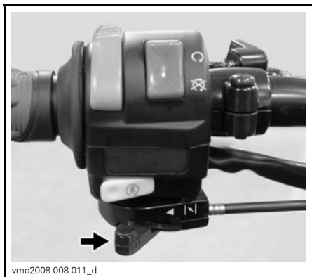
CHOKE IN VOLLSTÄNDIG GEÖFFNETER POSITION
