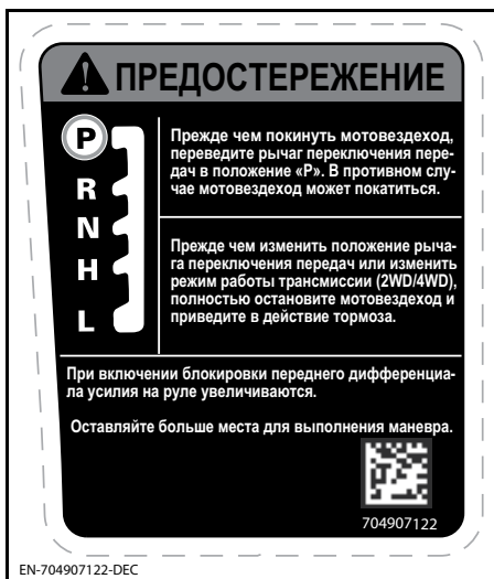
НАКЛЕЙКА 4 — МОДЕЛИ С ПЕРЕДНИМ ДИФФЕРЕНЦИАЛОМ SMART-LOK
