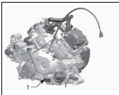
TÍPICO 800 E 1000 — ETIQUETA DO NÚMERO DE SÉRIE DO MOTOR
