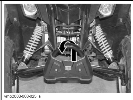
LOCAL DE FIXAÇÃO À FRENTE
