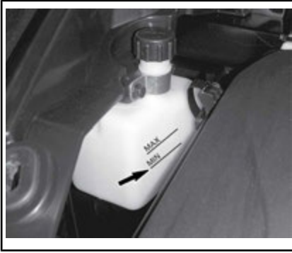
DEPÓSITO DE EXPANSIÓN DEL REFRIGERANTE
