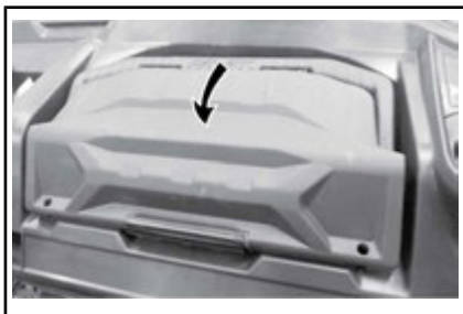
DESTRAVAMENTO DA CAIXA DE FERRAMENTAS REMOVÍVEL
