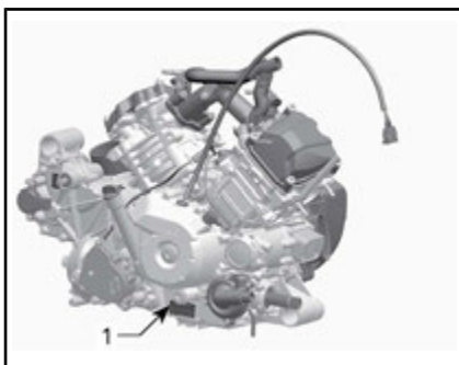
TÍPICO HD8 E HD10 – ETIQUETA DO NÚMERO DE SÉRIE DO MOTOR
