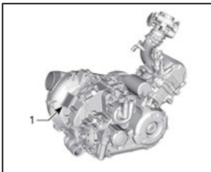
TÍPICO HD5 – ETIQUETA DO NÚMERO DE SÉRIE DO MOTOR
