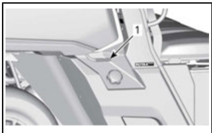
1. Alça de liberação do compartimento de carga
