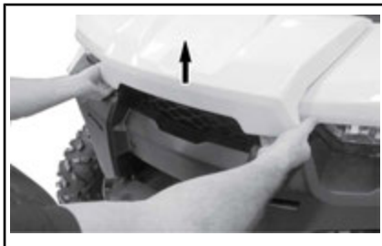
LEVANTAMIENTO DEL BORDE DE LA TAPA DE ACCESO DELANTERA.
