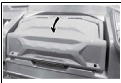
DESBLOQUEO DE LA CAJA DE HERRAMIENTAS EXTRAÍBLE
