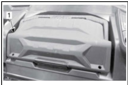
DESBLOQUEO DE LA CAJA DE HERRAMIENTAS EXTRAÍBLE
