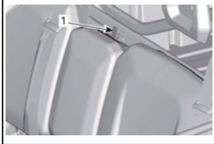
1. Típico - mecanismo de bloqueo del clip del respaldo
