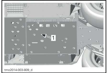
1. Пробка сливного отверстия
