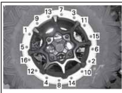
VANLIG – ÅTDRAGNINGSEKVENSS
