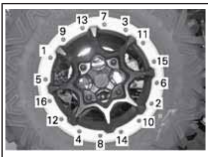
VANLIG – ÅTDRAGNINGSEKVENSS
