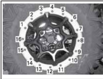
VANLIG – SISTA-ÅTDRAGNINGSSSEKVENSENS
