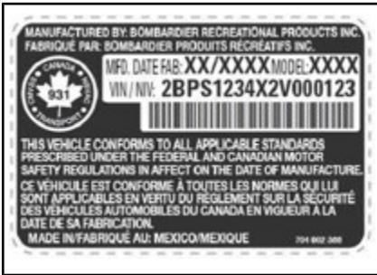
TYPISCH — HINWEISSCHILD MIT FAHRZEUGSERIENNUMMER UNTER HANDSCHUHFACH
