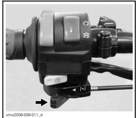
CHOKE IN VOLLSTÄNDIG GEÖFFNETER POSITION
