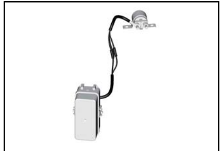
SÄKRINGSLEDNING ANSLUTEN TILL SÄKRINGSBOX
