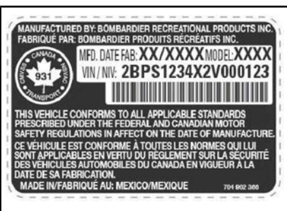
TYPBILD — DEKAL FÖR FORDONETS TILLVERKNINGSNUMMER UNDER HANDSKFACKET
