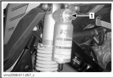
1. Kompressionsjusterare (flat skruvmejsel)
